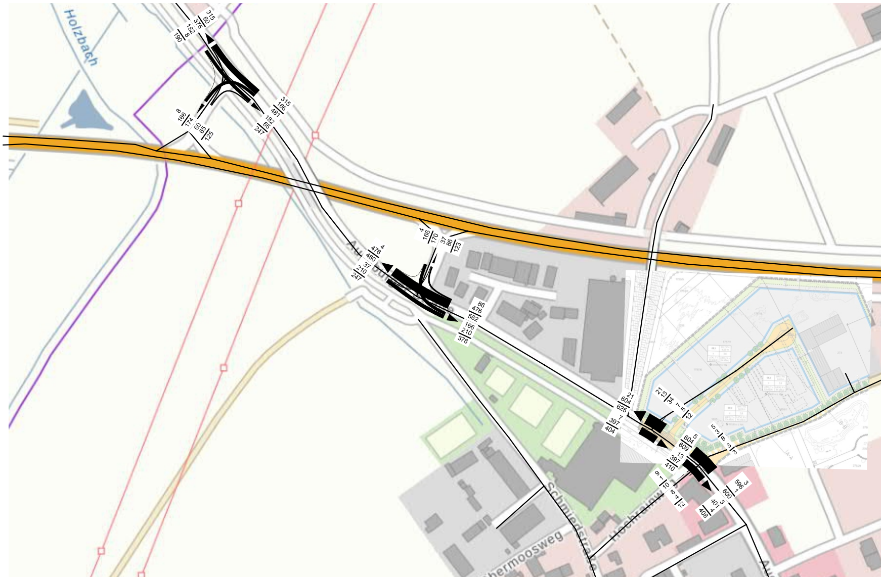
Anlage 4.3 Gesamtprognose 2040 Abendspitze Knotenstrombelastungen Kfz/h
