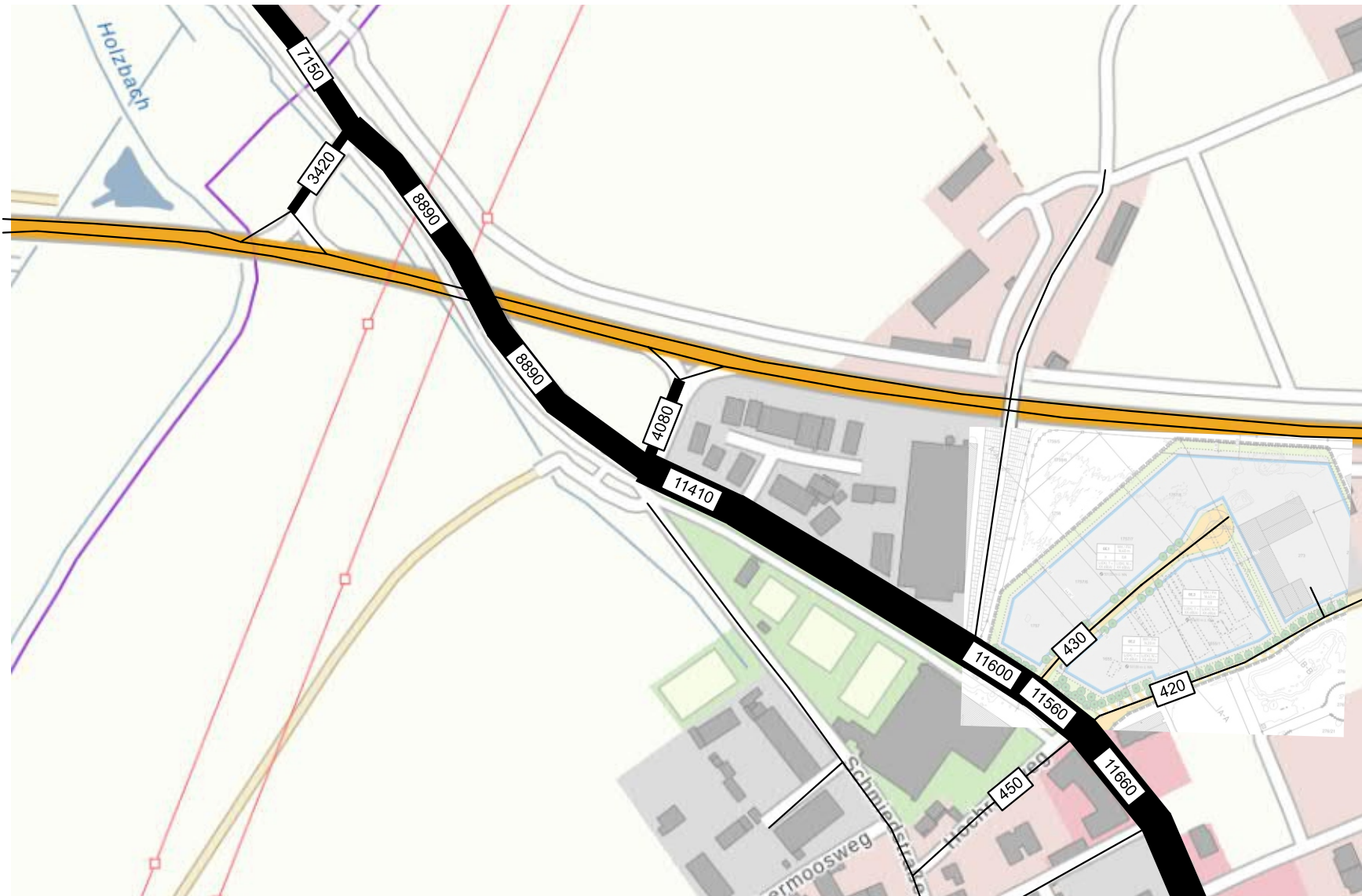
Anlage 4.1 Gesamtprognose 2040 Tagesverkehr Streckenbelastungen Kfz/24 h
