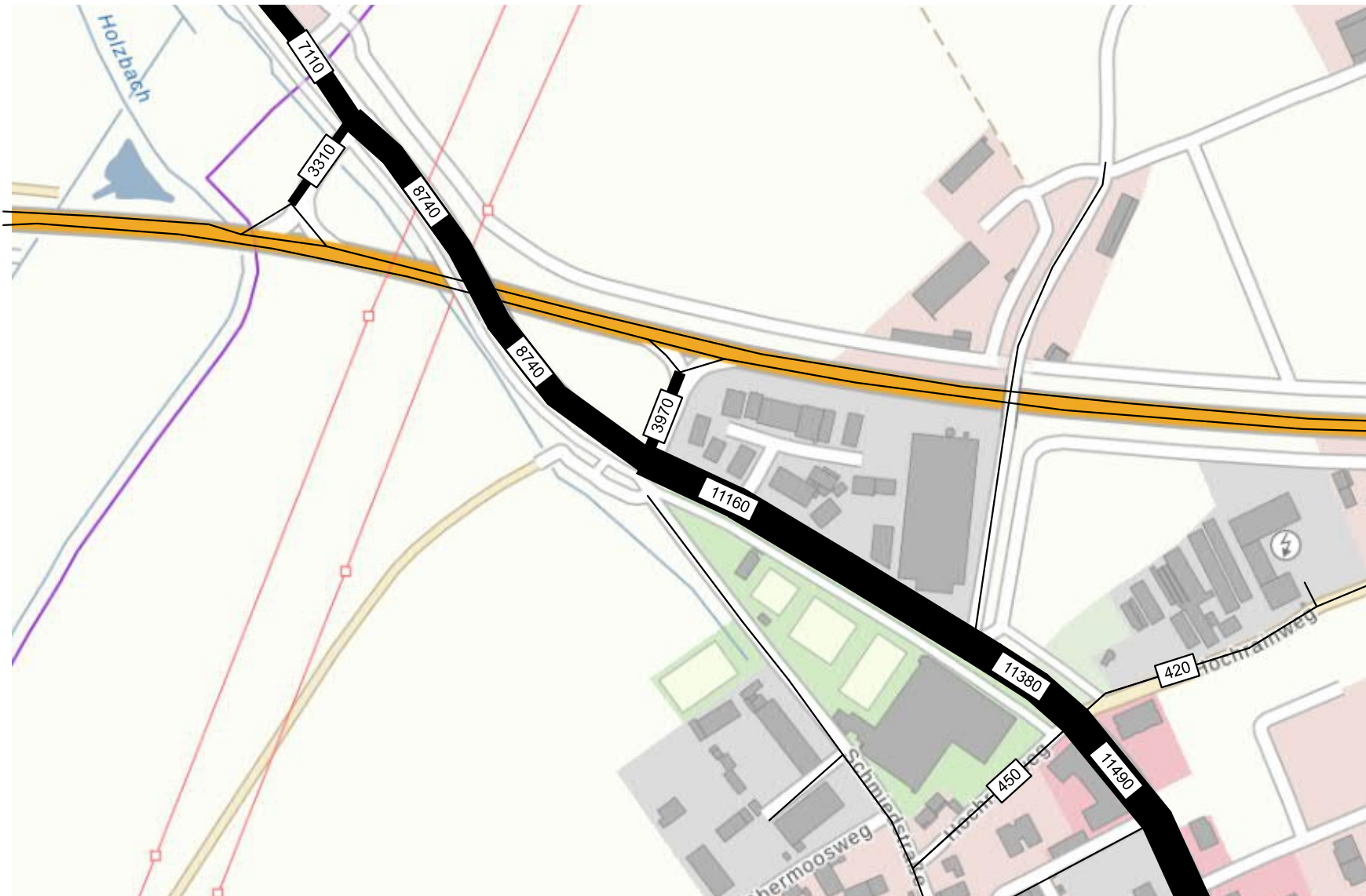
Anlage 3.1 Prognose Nullfall 2040 Tagesverkehr Streckenbelastungen Kfz/24 h
