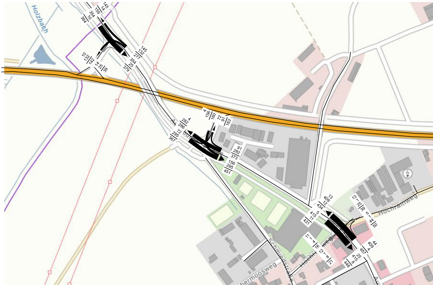
Anlage 3.2 Prognose Nullfall 2040 Morgenspitze Knotenstrombelastungen Kfz/h
