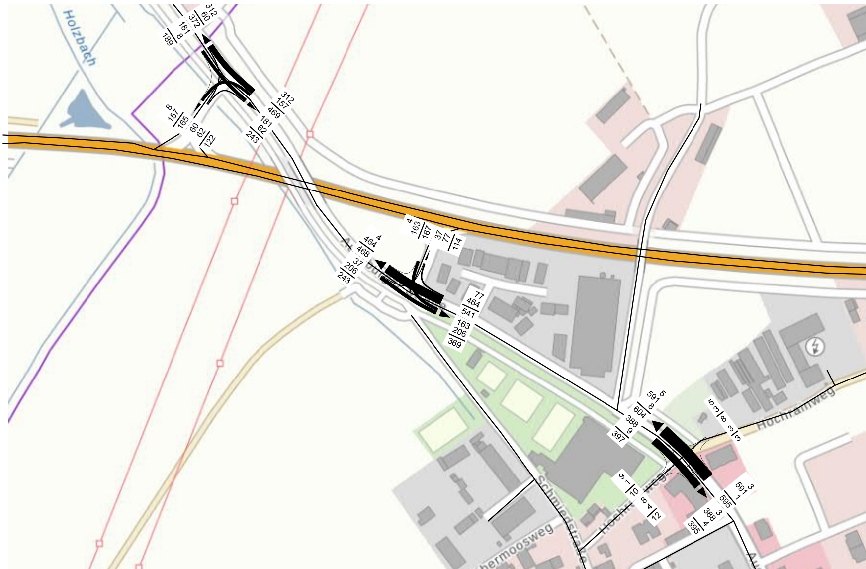
Anlage 3.3 Prognose Nullfall 2040 Abendspitze Knotenstrombelastungen Kfz/h
