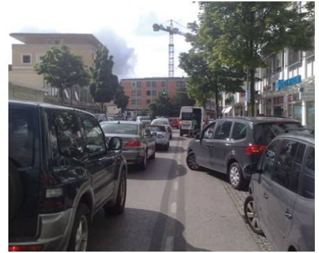
Foto Germering, Untere Bahnhofstraße, „Zwischen Längsparkständen und Radschutzstreifen muss ein Sicherheitsabstand eingehalten werden. Ebenso sind Zonen für Lade- und Liefervorgänge freizuhalten.“ Büro Transver 2012
