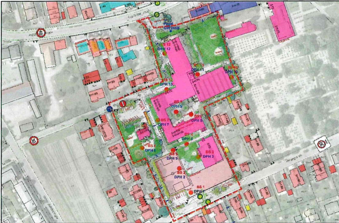
Abb. 2: Bestandsaufnahme 08-2022 mit DOP20 vom 04.06.2022, mit Bestand, Freiflächen und derzeitigen Nutzungen, magenta: öffentliche Nutzung, mittelrot: Wohnnutzung, rot: Garagen, cyan: Dienstleistung, orange: Einzelhandel, blau: Handwerk/Gewerbe, rote Punkte: Sondierbohrungen/Rammsonden, rot: Geltungsbereich, Plangrundlage © LVG-Bayern (Originalmaßstab 1/1.000)
